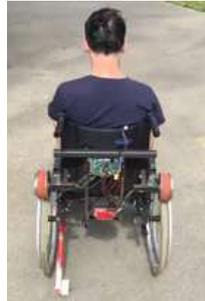
Quelques bénévoles se retrouvent au LaboCesson pour explorer une idée folle : électrifier un fauteuil manuel avec un Hoverboard en fin de vie et contrôler le tout avec un joystick de console... et ça marche !
