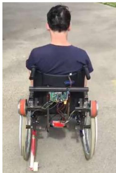
Le projet consiste à utiliser des moteurs d'un HoverBoard (récupérés sur de l'équipement en panne par exemple) pour motoriser un fauteuil roulant par entraînement des roues grâce au frottement entre les moteurs et les roues, le tout piloté par un joystick d'une manette de console vidéo. Gaël, Suliane, André et Nicolas Pousset, déjà très investis sur les projets de mobilité ont réalisé l'ensemble des recherches et des développements permettant de réaliser le premier prototype fonctionnel.
