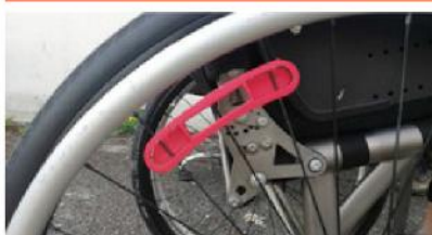
Test sur une roue de fauteuil d'un élément de fixation de catadioptre
